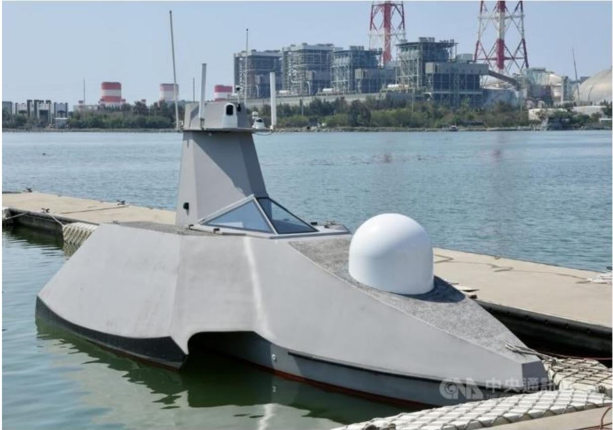
台船公司25日在高雄公開亮相自主研發的無人船「奮進魔鬼魚」，船長8.6米、船寬3.7米、酬載高於1噸、最高航速35節以上。中央社記者張皓安攝 114年3月25日
